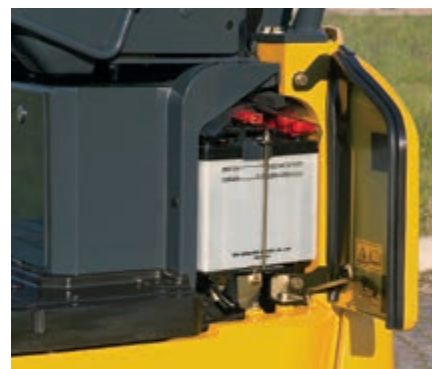
Cofano sinistro: accesso alla batteria
